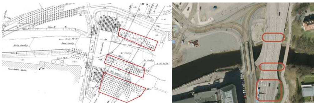
Figur 20 Utdrag ur ritning nummer 1926–86 samt ortofoto. Röda cirkclar markerar ungefärligt område för bankpålar för befintlig vägbro i Gamlestadsvägen, dvs endast principskiss för orientering.
