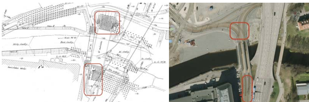
Figur 19 Utdrag ur ritning nummer 1926–86 samt ortofoto. Röda cirkclar markerar ungefärligt område för bankpålar tillhörande den rivna Gamlestadsbron, dvs endast principskiss för orientering.
