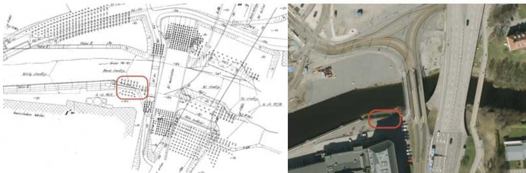
Figur 15 Utdrag ur ritning 1926–86 samt ortofoto. Röda cirklar markerar ungefärligt område för bankpålar i anslutning till AS 1600-ledning, dvs endast principskiss för orientering.
