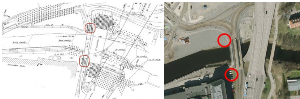
Figur 16 Utdrag ur ritning nummer 1926–86 samt ortofoto. Röda cirklar markerar ungefärligt område för bankpålar tillhörande en riven GC-bro, dvs endast principskiss för orientering.
